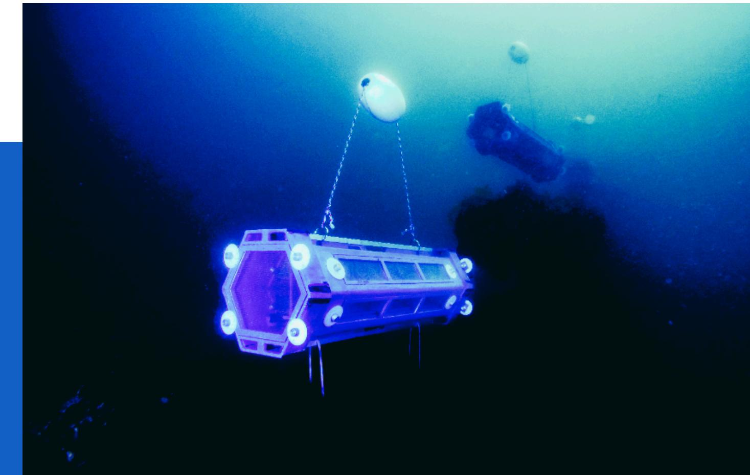
El dispositivo altamente funcional, atrae de manera natural a las presas de las larvas, funciona como fuente nutricional de alimento a través de un sustrato bioatractante artificialmente enriquecido con una biopelícula de microalgas y bacterias de alto valor nutricional en omega 3 y 6. Esto, facilita una mayor tasa de supervivencia y el escalamiento industrial de producción de una determinada especie.
