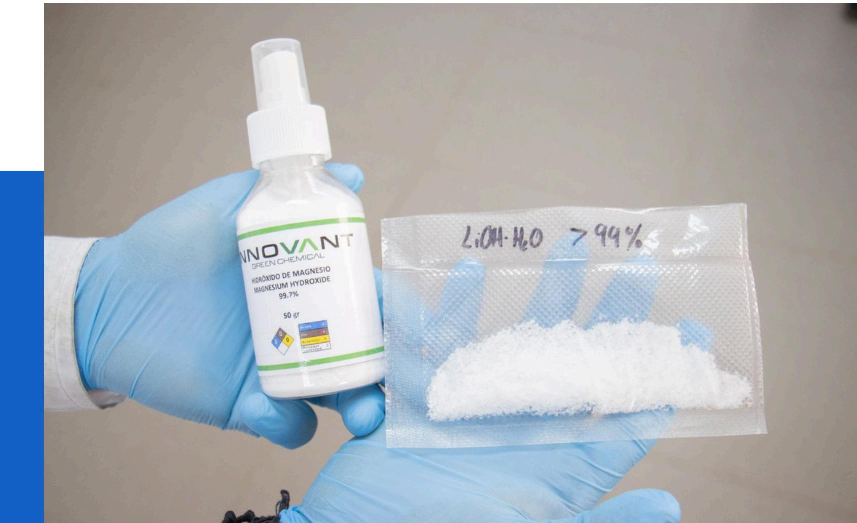
De uso directo en el proceso de bischofita de descarte con una composición determinada y sin tratamiento previo, uso exclusivo de  $NaOH$  como álcali y una solución de  $NaCl$  como medio de reacción y aditivo de cristalización, y el control del flujo de alimentación de los reactivos.
